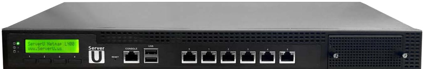
ServerU Netmap L-400 é um appliance de rede 1U perfeito para empresas e organizações de médio porte. É equipado com 6 redes Intel Gigabit LAN com filas multithread independentes para RX e TX, controles de interrupções MSI-X e preparado para a tecnologia Netmap de processamento de pacotes de alta performance.
